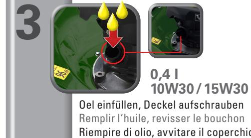
Oel einfüllen, Deckel aufschrauben
